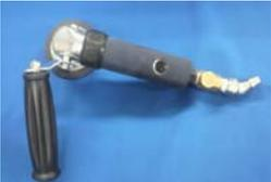
U-TOOLのトルク重視型のミニポリッシャーです。従来のミニポリッシャーのように圧力を掛けても回転が停止せず、本格的な作業が可能です。
