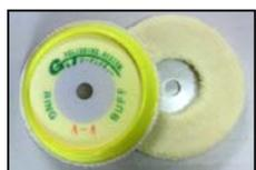
テーパータイプのウールバフです。業界で最も短い毛足のウールバフA-4の他A-6・A-8・A-12と4種類の毛足を用意しました。肌の調整力は、毛足が短いA-4が最強です。又、仕上がりと、研磨時の発熱防止には、毛足の長いA-12が有効です。用途に合わせて好きな毛足を選択して下さい。
