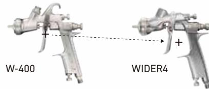
従来形式より全体で25gの軽量化を行いました。また、本体全長を3.5mm縮小、グリップを5.0mm延長させることで、重心位置を手元側に移動させました。これによりハンドリングが大幅に向上し、疲労軽減と作業の効率化が見込めます。
