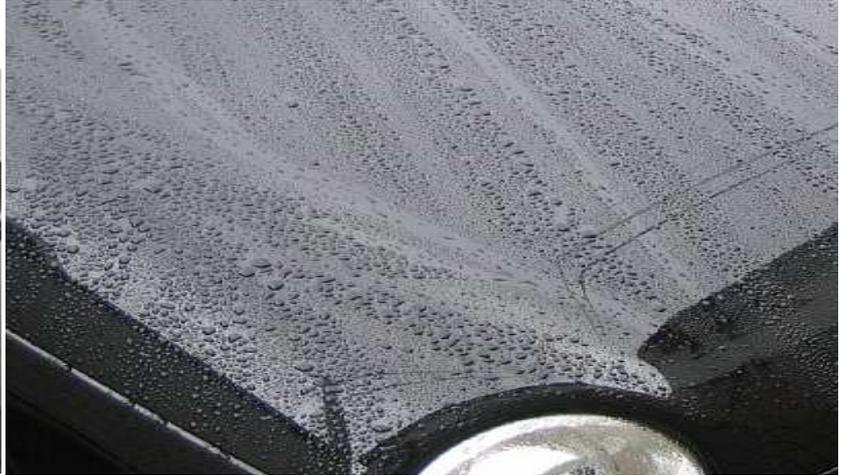
G-LUSTERは、シリコン結合 (Si - O - Si) を主骨格とする無機系コーティング膜を常温で形成します。硬化膜はガラス質の成分で構成され、傷につき難く汚れも浸透し難い、優れた性能を持ちます。
